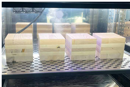
Condizionamento del legno
