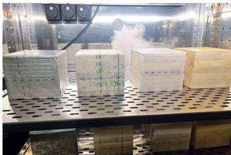
Simulation de la phase de chantier
