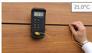
Temperatura de la pared interna
