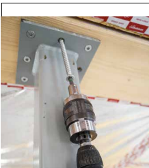
TORQUE LIMITER DREHMOMENTBEGRENZER
