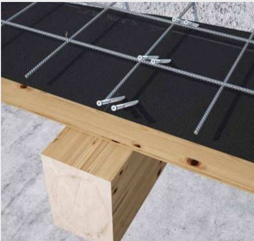
木-混凝土复合楼板，采用 30°螺钉双排排列。
