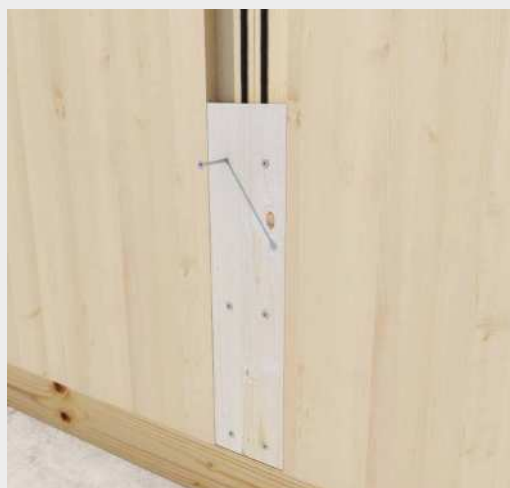
^ CLT panelek rögzítése 6 mm átmérőjű HBS csavarokkal.
