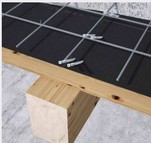
Взаимодействующее перекрытие дерево-бетон с расположением соединителей под углом а 30° в двойном ряду.
