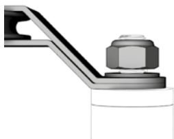
Installazione corretta PATROLANG su sostegno TOWER - TOWER22 - TOWERA2
