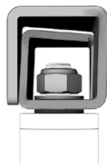
Installazione corretta PATROLINT su sostegno TOWER - TOWER22 - TOWERA2
