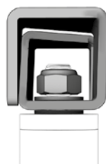
Instalación correcta PATROLINT en soporte TOWER - TOWER22 - TOWERA2
