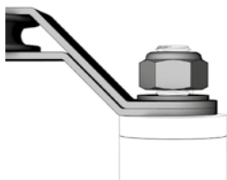
Instalación correcta PATROLANG en soporte TOWER - TOWER22 - TOWERA2
