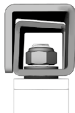
Instalação correcta do PATROLINT sobre o suporte TOWER - TOWER22 - TOWERA2
