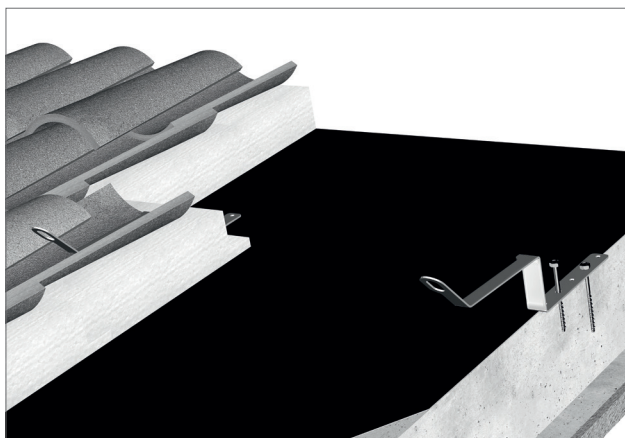
Montaggio su tetto in cemento
