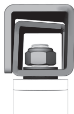
Fachgerechte Installation von PATROLINT auf TOWER - TOWER22 - TOWERA2 Stütze
