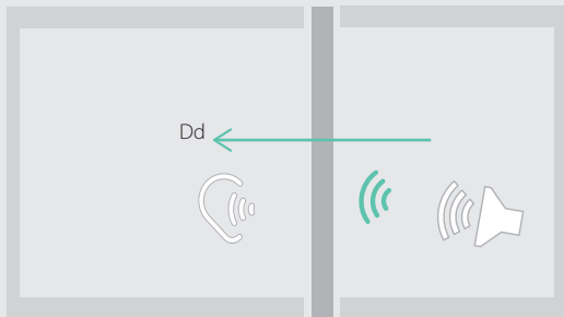
Abb 1.4 Labormessungen des Schalldämmmaßes R: direkte Übertragung.
