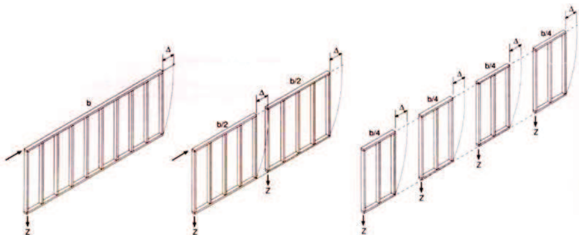
Darstellung der Auslenkung gemäss [2]
