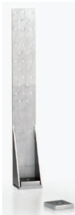
WHT440 30 Kammnägel 4x60 t = 2 min 1 M16x190 + VINYLPRO t = 2,75 min
