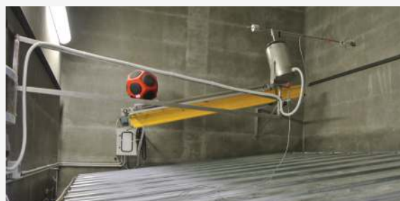
Zdjęcie 1: fotografia próbki po stronie pomieszczenia emitującego
