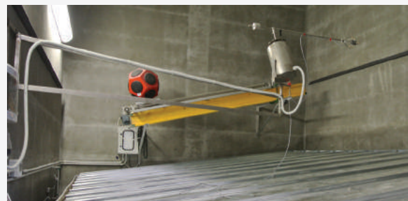
Φωτογραφία 1: φωτογραφία δοκιμίου, πλευρά θάλαμου εκπομπής
