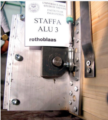
对尺寸缩小的样本进行测试（木材到木材和木材到混凝土）
