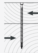
Angolo tra forza e fibre \alpha = 90^\circ
