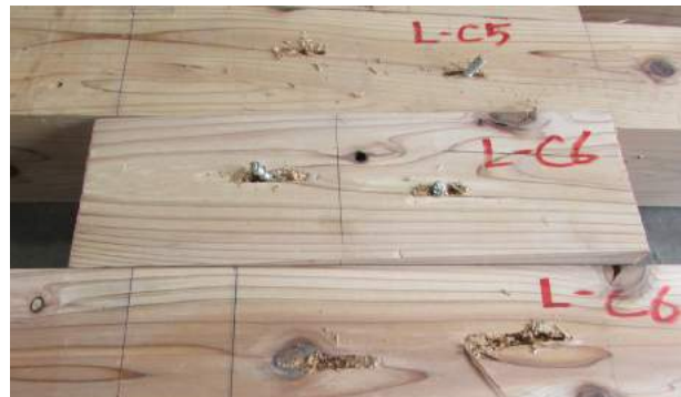
構造用製材とHBS8180の荷重-変異曲線（下）と破壊状況（上）
