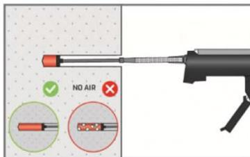
8. Den Verfüllstutzen bis zum Bohrlochgrund einführen und den Mörtel injizieren. Wird der Bohrlochgrund nicht erreicht, muss eine passende Mischerverlängerung verwendet werden. Während des Initiierens wird der Verfüllstutzen durch den Staudruck des Mörtels auf natürliche Weise aus dem Bohrloch gedrückt. Die temperaturrelevanten Verarbeitungszeiten (Tabelle B4) sind zu beachten.
