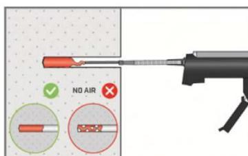
6. Gereinigtes Bohrloch vom Bohrlochgrund her ca. zu 2/3 mit Verbundmörtel befüllen. Langsames Zurückziehen des Statikmischers aus dem Bohrloch verhindert die Bildung von Lufteinschlüssen. Wird der Bohrlochgrund nicht erreicht, muss eine passende Mischerverlängerung verwendet werden. Die temperaturrelevanten Verarbeitungszeiten (Tabelle B5) sind zu beachten.
