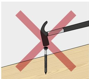
Ne pas frapper sur les vis pour insérer la pointe dans le bois.
