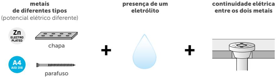
Quanto mais dissimilares forem os metais (maior diferença potencial), maior será o risco de corrosão. O potencial de corrosão galvânica entre metais é ditado pela distância entre eles na "série galvânica de metais". Grosso modo, uma diferença de potencial superior a 0,4-0,5 V pode ser considerada significativa/crítica.
