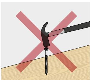
Não martelar os parafusos para inserir a broca na madeira.
