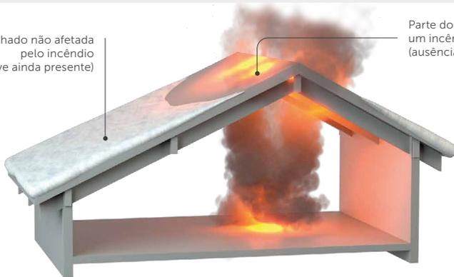
Parte do telhado afetada por um incêndio (ausência de neve)
