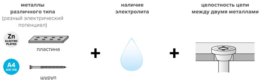
Чем разнороднее металлы (больше разность потенциалов), тем выше риск коррозии. Возможность гальванической коррозии между металлами определяется тем, насколько далеко они находятся друг от друга в «гальваническом ряду металлов». В целом, разность потенциалов более 0,4-0,5 В можно считать значительной (критической).
