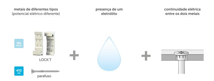
A versão LOCK T EVO com revestimento em pó de poliéster resolve eficazmente este problema, isolando eletricamente as peças e evitando assim a corrosão galvânica. Esta solução garante maior durabilidade e fiabilidade na aplicação dos conectores LOCK T, mesmo em ambientes com humidade<sup>(1)</sup>
