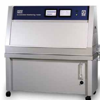
Peć s ultraljubičastim (UV) zračenjem za starenje
