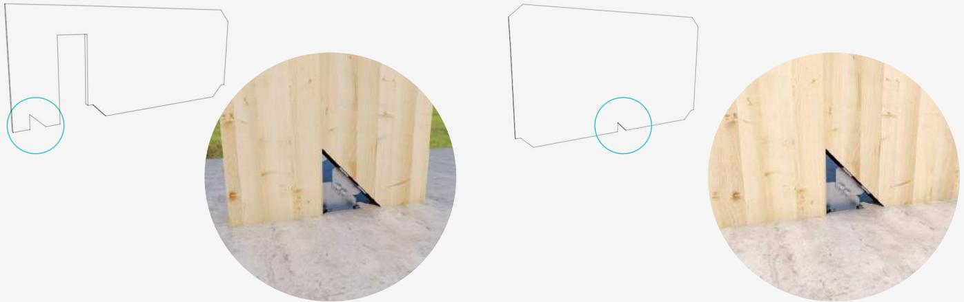
Cuando se requiera una fijación a cimientos para paredes no estructurales o una fijación temporal para la correcta alineación de la pared (ej. paredes de longitud importante), se puede instalar en el ángulo inferior del panel de CLT (con corte de 45° simplificado sin recorte horizontal) la placa BEASYT (en alternativa a la X-ONE) y en la solera de cimentación la placa BEASYC (en alternativa a las placas X-PLATE BASE) <sup>(1)</sup>.
