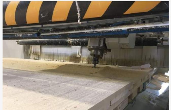
Operaciones de corte con sierra circular y fresa frontal para la realización de la geometría necesaria para el posicionamiento del X-ONE.
